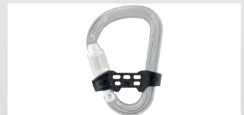
『バー』は『アタッシュ』に付け外し可能で、横軸方向に荷重がかかるのを防ぎます
